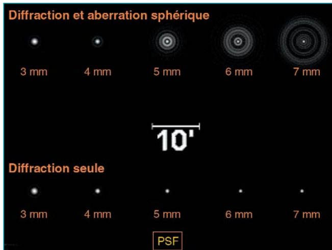
Fig. 3 : Comparaison pour différents diamètres pupillaires des images rétinienne d'un point lumineux : en présence de diffraction et d'aberration sphérique (en haut), et en présence de diffraction seule (en bas). Alors que la dilatation pupillaire réduit l'effet de la diffraction, elle augmente celui de l'aberration sphérique (dans cet exemple, le taux d'aberration sphérique positive est équivalent à 0,3 micron à 6 mm, soit le taux moyen observé chez les sujets opérés de cataracte après implantation d'un implant sphérique conventionnel). (Illustration : D. Gatinel)
